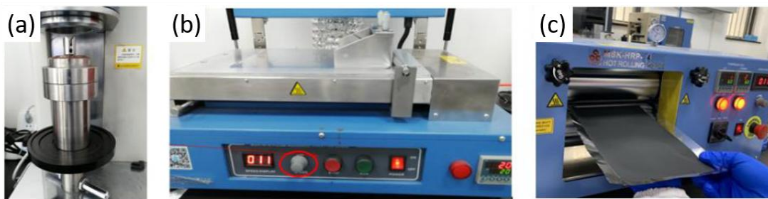
图 1 正极样品主要的制备工艺，(a)打浆，(b)涂布，(c)辊压 [15]
